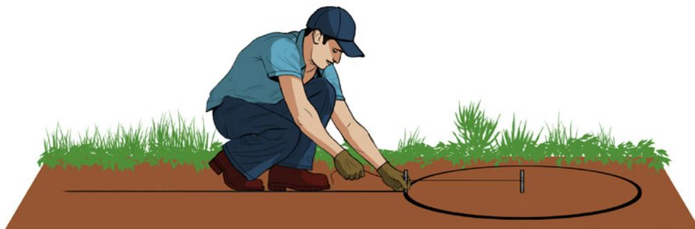
**Figura 23:** Replanteo del pozo de absorción trazando un círculo en el suelo.
