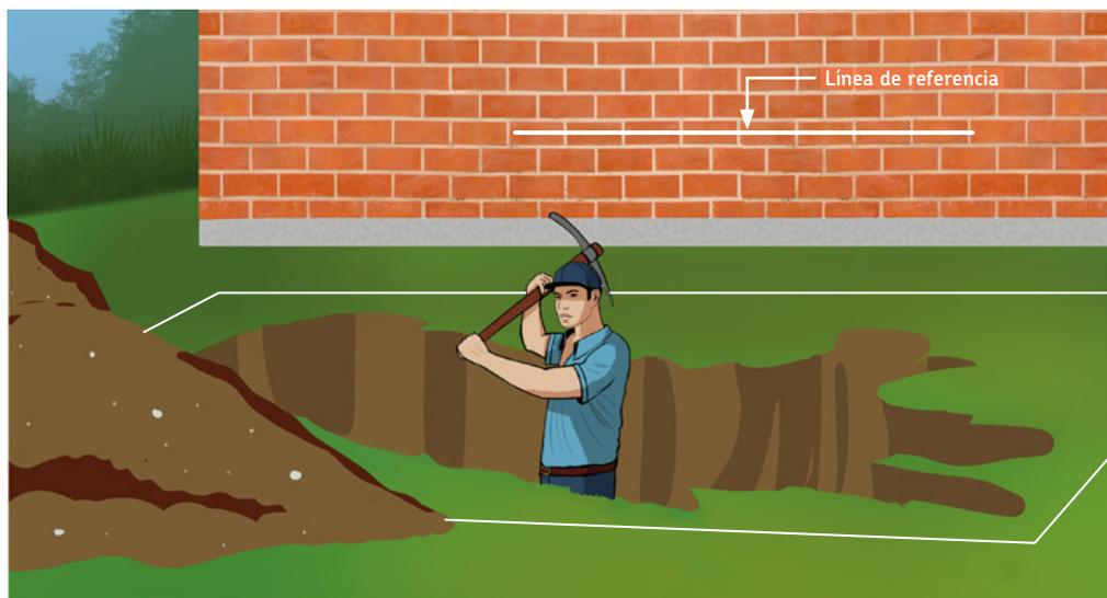
**Figura 24:** Proceso de excavación, tomando una línea de referencia sobre una pared o estructura fija para el control de profundidad y nivelación.
