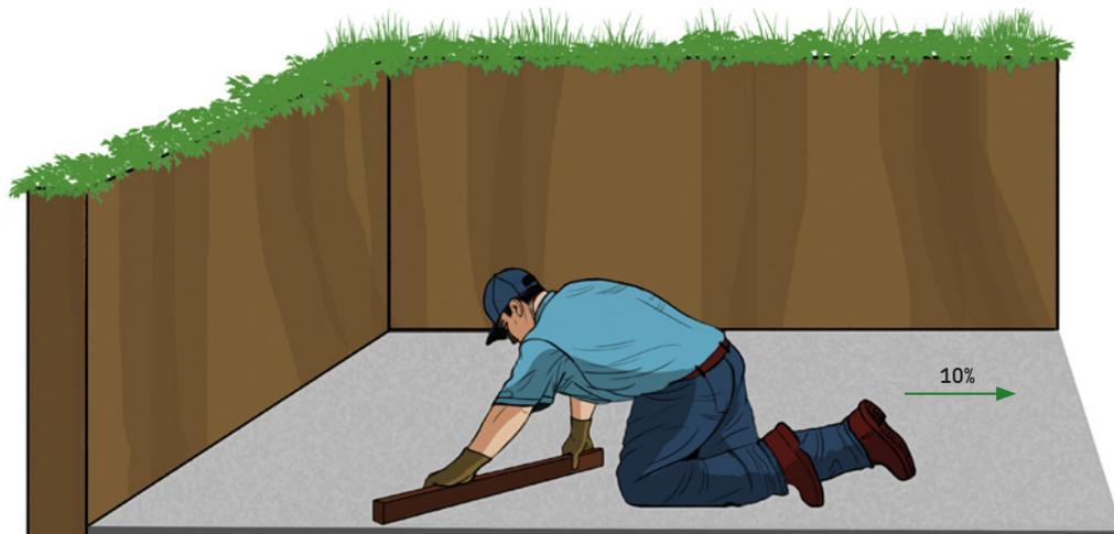
**Figura 27:** Vaciado del piso sobre el emparrillado. La pendiente debe estar orientada al centro del Compartimento 1.
