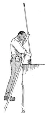
Limpieza del tanque con una escoba
